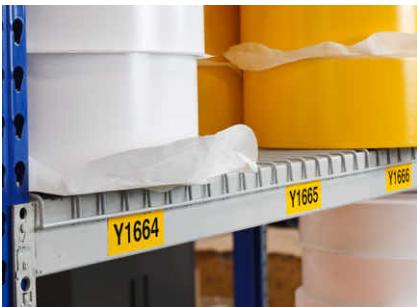
Kennzeichnung für die Lagerhaltung nach dem Lean-Prinzip
